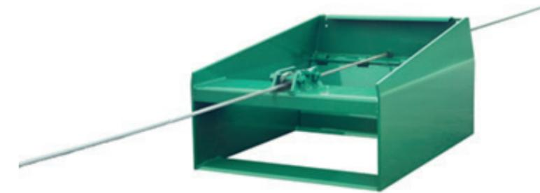
Als Ergänzung zu unserem Angebot an Mistschiebern bieten wir den Querkanalschieber an. Bei diesem System wird die Gülle aus mehreren Kanälen in einen Querkanal geleitet. Der Querkanalschieber bringt die Gülle in eine zentrale Grube. Der Querkanalschieber kann eine Schlaglänge von bis zu 37 Metern erreichen. Übersteigt die Schlaglänge diesen Wert, muss ein zweiter Querkanalschieber verwendet werden. Der Duo Compact II Antrieb wird häufig als Antriebseinheit verwendet.
